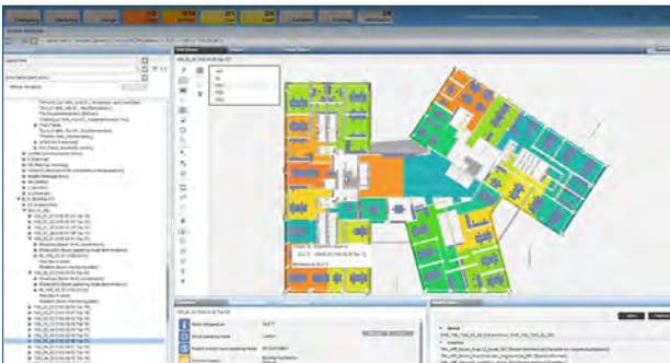
Bild 3 , Visualisierung von Daten über die Flächen/Räume des BIM-Modells (via, Draufsicht) – Farbverlauf: unterschiedliche Farben stellen die unterschiedlichen Temperaturen dar
