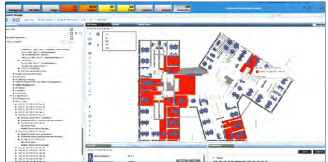
Bild 2 , Visualisierung von Daten über die Flächen/Räume des BIM-Modells (via, Draufsicht) – in Rot: Räume mit geöffneten Fenstern
